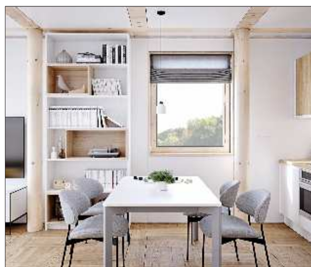
In den Holz-Skelettbau ausgeführten Gebäuden gibt es keine tragenden Innen- oder Außenwände. Foto: Viscato
